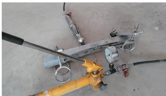
图 5 注胶卡具及手动液压泵照片
