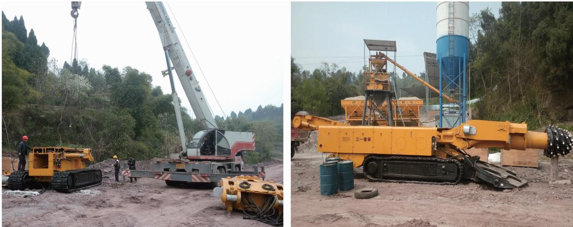
图 2 悬臂式纵轴掘进机组装
