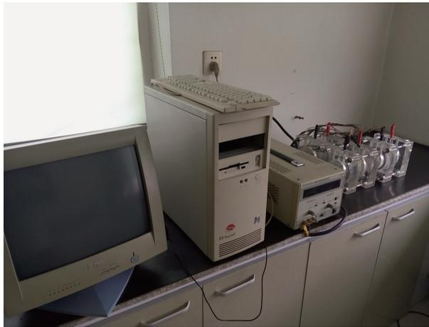
图3 电通量法试验仪器(混凝土渗透性快速测定仪)
