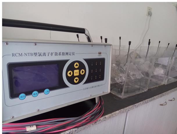
图5 混凝土扩散系数测定仪
