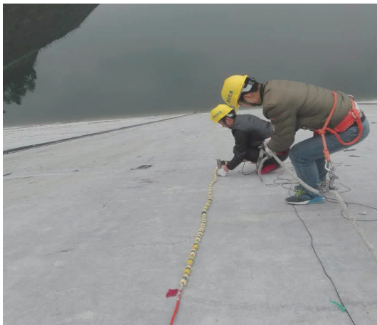
图6 散射勘探技术的堆石坝面板脱空检测
