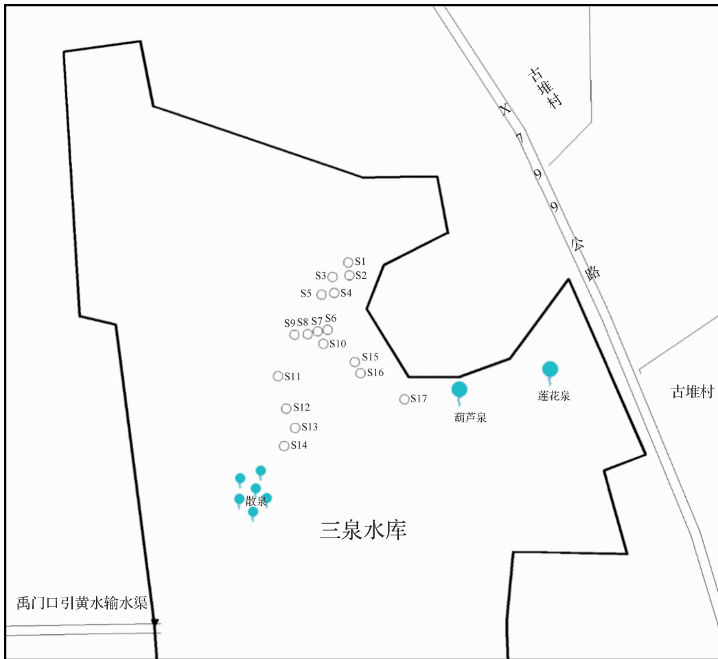
图1 三泉水库库区主渗漏区、渗漏点分布
