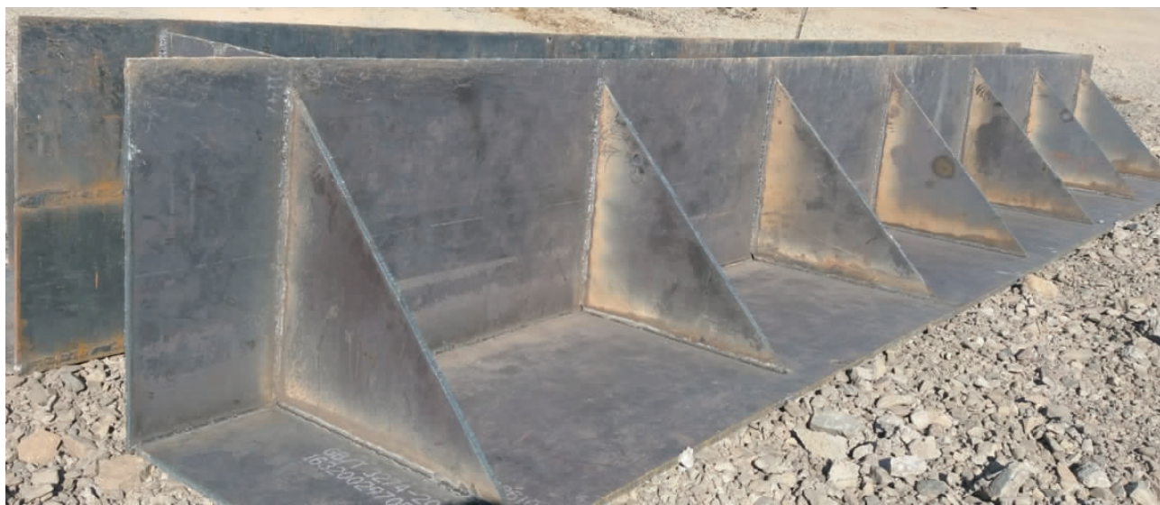
图 2 移动式钢板结构导墙外观
