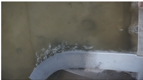
图1 原方案溢洪道进口水流流态
