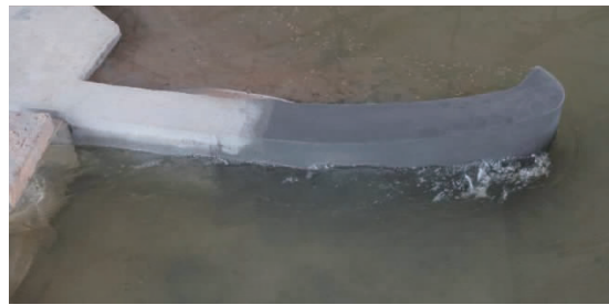
图4 方案三溢洪道进口水流流态
