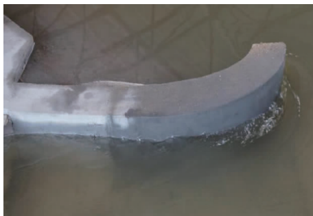
图2 方案一溢洪道进口水流流态
