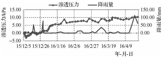
图2 基岩渗流监测渗压计SY4渗透压力和降雨量变化曲线
