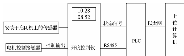
图 2 闸门开度控制仪框架
